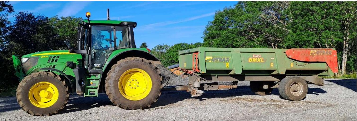
*tracteur John Deere 130 CV 4 roues motrices et la benne monocoque 13 tonnes*
