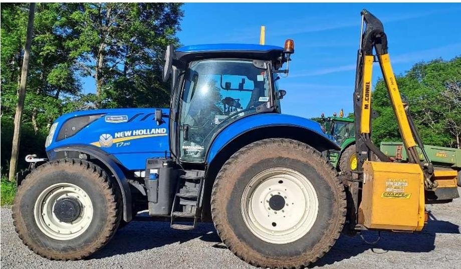
*Tracteur New Holland 160 CV et l'épareuse*
